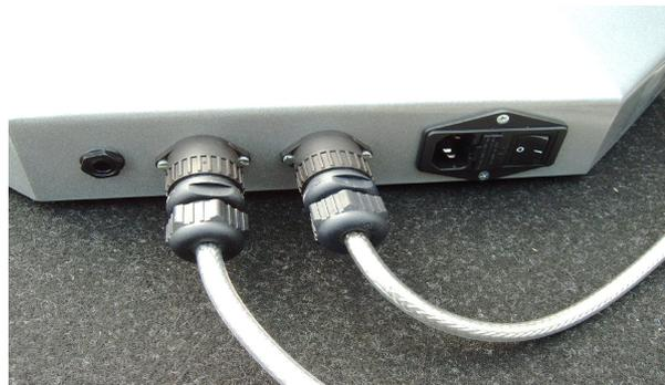
2. Ein Ende des Netzkabels in die Steckdose und das andere Ende in den VIBRAFIT® classic einstecken. Das Stromkabel ist so zu verlegen, dass keine Stolpergefahr besteht. Das Stromkabel nicht auf Zug belasten.
